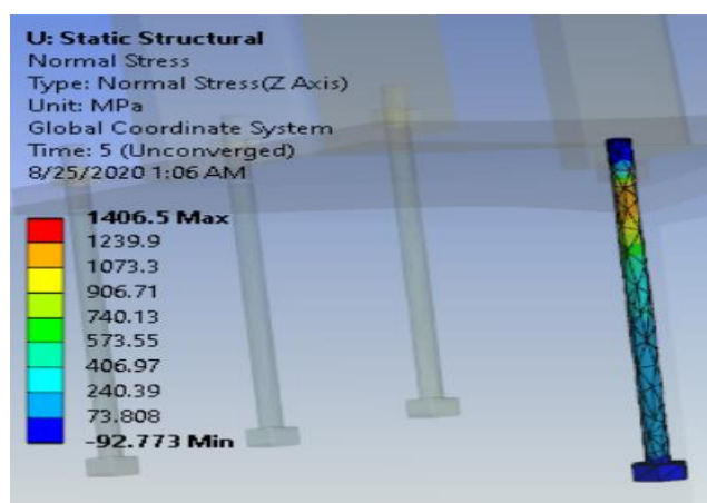
Gambar 4.58: Tegangan yang terjadi pada angkur 1 base plate tanpa stiffeners TP 40 B 6
