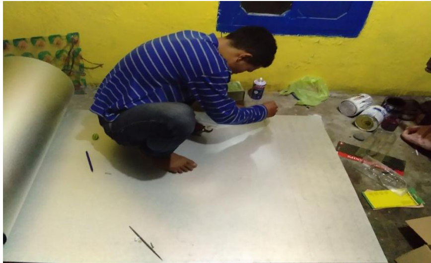
Gambar 3.21 Menggambar konsep desain sirip
