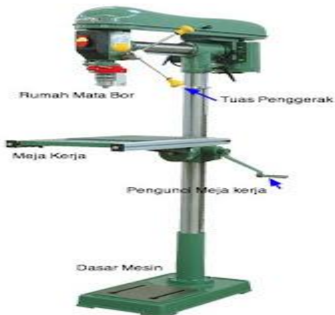
Gambar 2.23. Mesin Bor Meja (wiliamcooler.proses permesinan)
