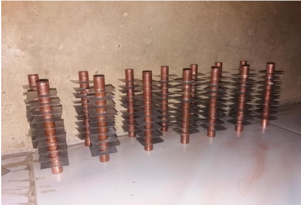
Gambar 3.27 Memasang sirip ke pipa tembaga, jarak sirip \pm 10\text{ mm}
