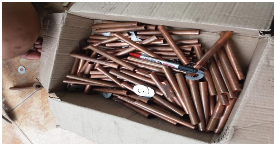
Gambar 3.22 Hasil potong pipa tembaga dengan ukuran 120 mm
