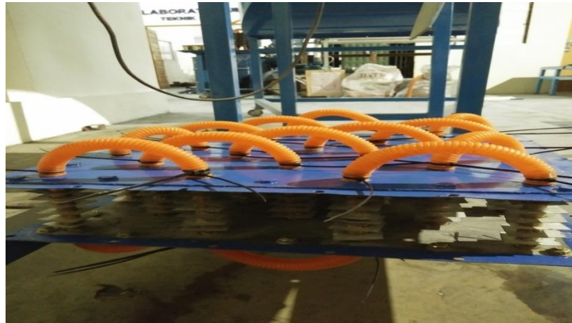
Gambar 4.4 Alat penukar kalor model Fin-Tube dengan sirip bulat susunan selang - seling
