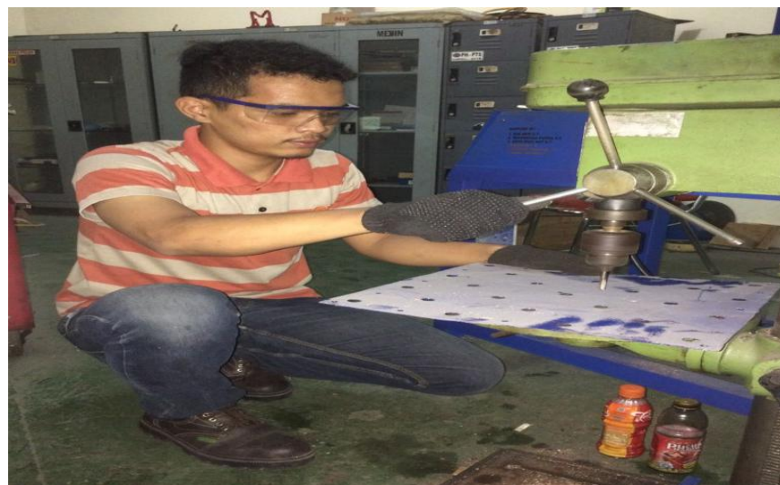
Gambar 3.23 Melubangi plat seng galvanis (sirip petak/bulat)
