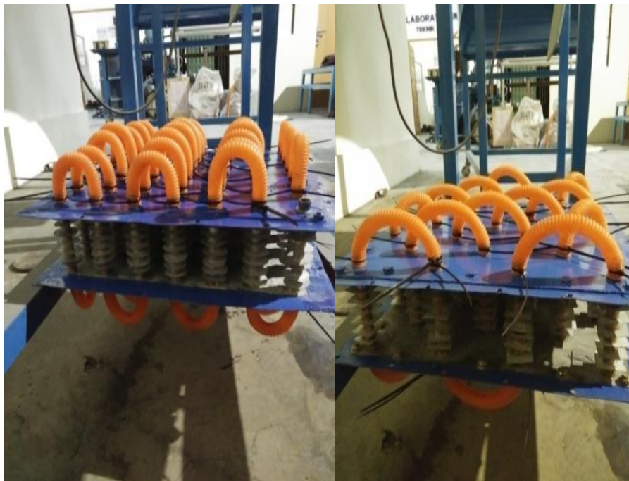
Gambar 3.30 Susunan selang air (a) sejajar dan (b) selang-seling
