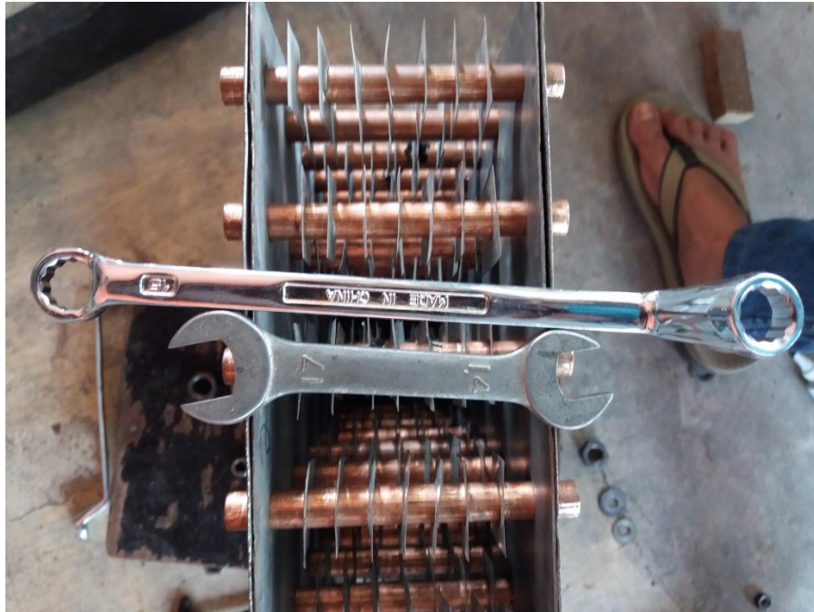
Gambar 3.29 Alat bantu untuk memasukan pipa tembaga kelubang plat besi, tebal 1,5 mm.( kunci pas/ring dan baut/mur 6 inch, 12mm x 14mm).
