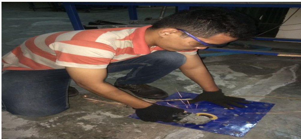
Gambar 3.25 Memotong plat besi sesuai konsep desain
