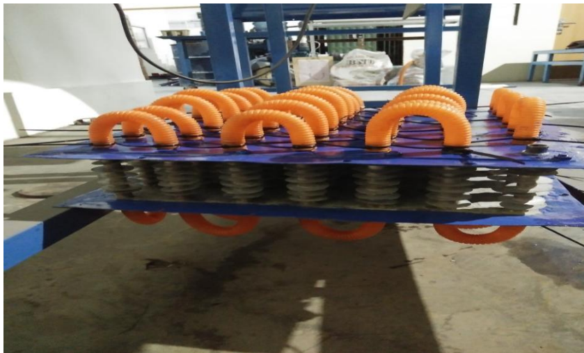
Gambar 4.3 Alat penukar kalor model Fin-Tube dengan sirip lingkaran susunan sejajar.
