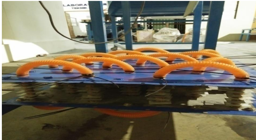
Gambar 4.2 Alat penukar kalor model Fin-Tube dengan sirip segi empat susunan selang - seling.
