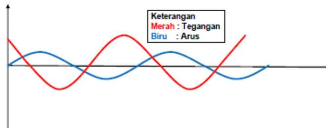
Gambar 2.11 Gelombang arus dan tegangan pada beban induktif
