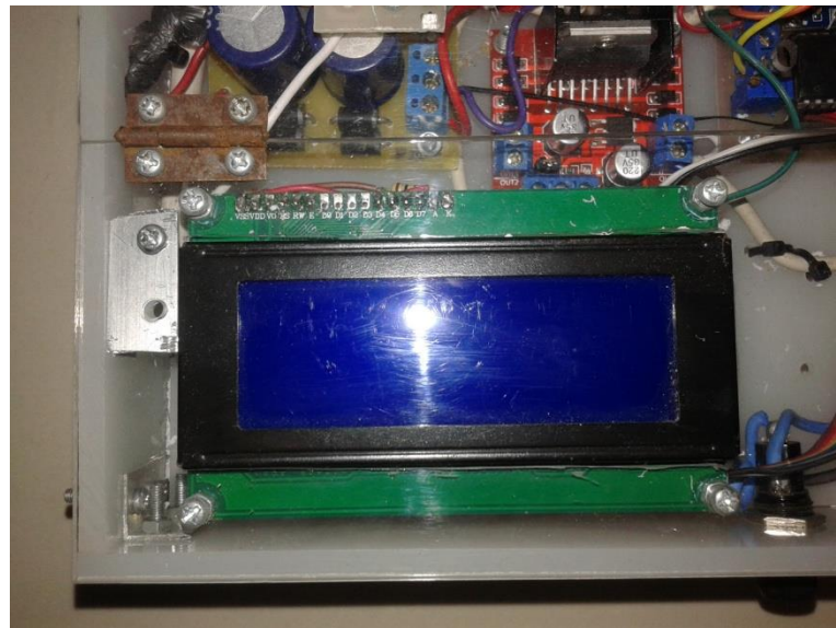
Gambar 4.3 Rangkaian LCD Karakter 20x4
