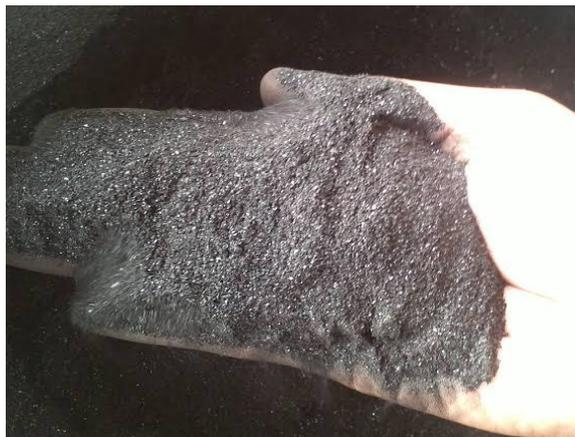
Gambar 2.1 : Abu Cangkang Kelapa Sawit
