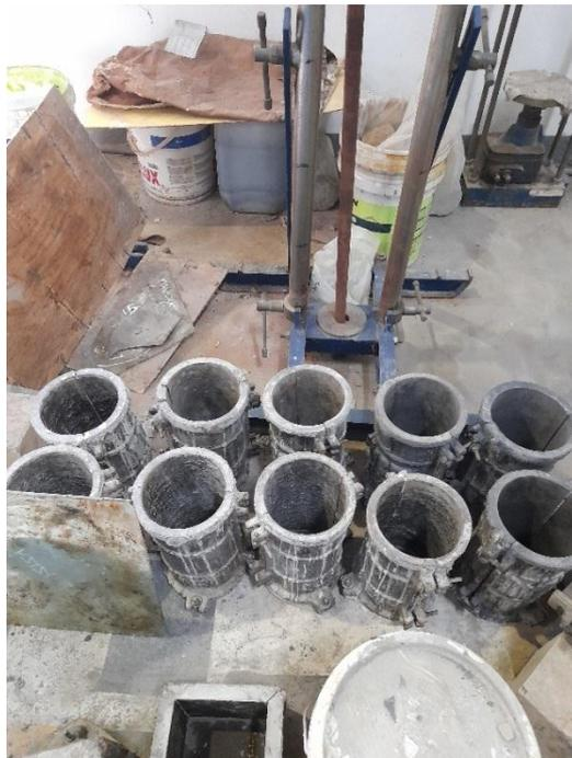
Gambar L- 4 : Cetakan Silinder
