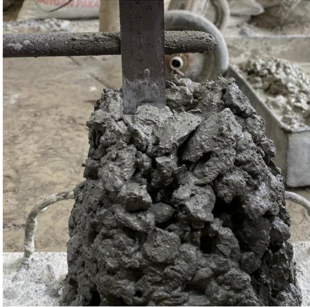
Gambar L- 27 : Pengujian Slump Test
