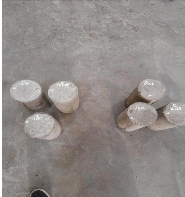
Gambar L- 31 : Beton Campuran Variasi Abu Cangkang Kelapa Sawit 15% dan Abu Cangkang Kelapa Sawit 20%
