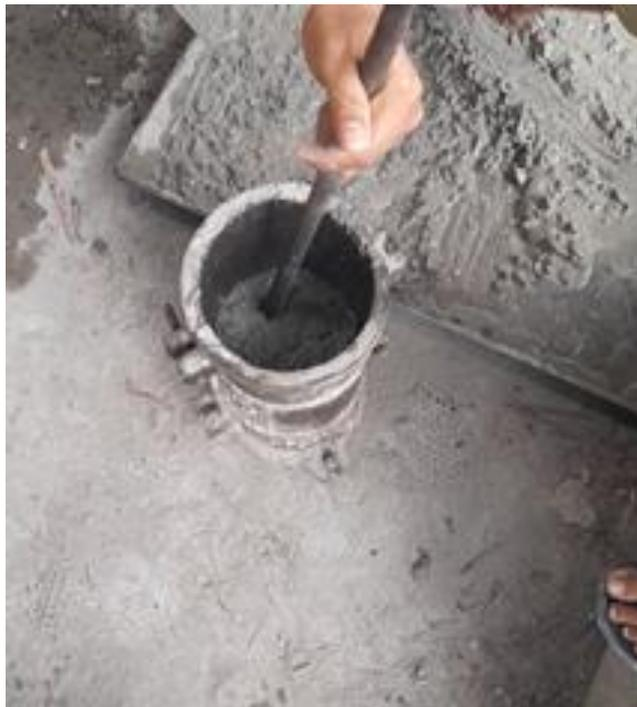
Gambar L- 28 : Perojkan Adukan Beton dicetakan
