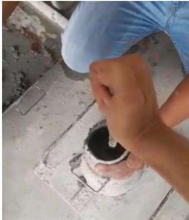
Gambar L- 26 : Merojok Pengujian Slump Test
