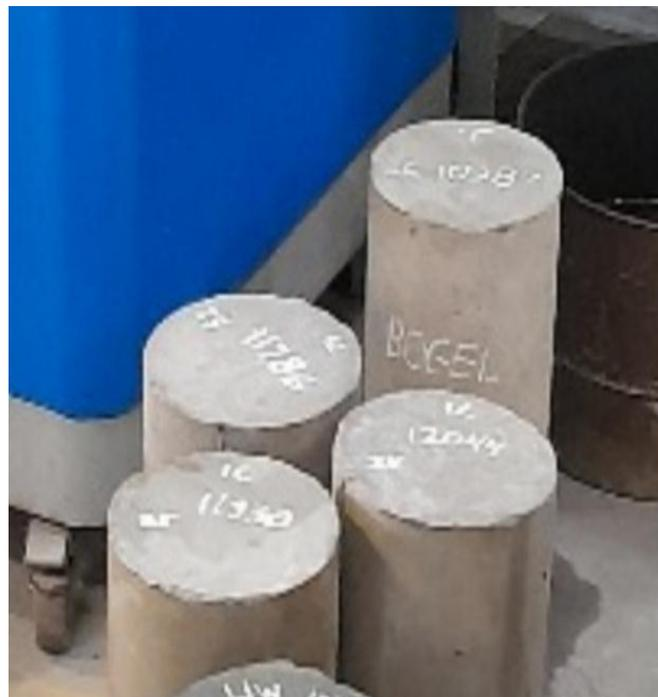
Gambar L- 32 : Beton Campuran Variasi Abu Cangkang Kelapa Sawit 25 %
