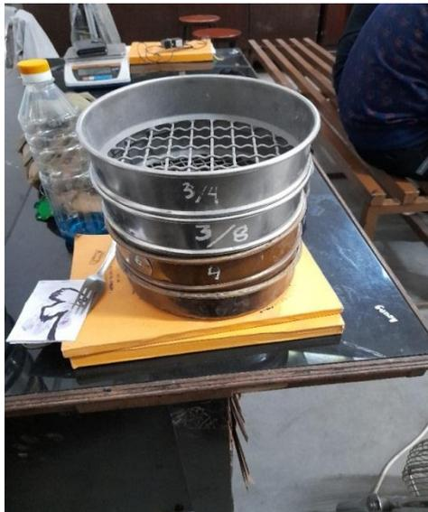
Gambar L- 2 : Saringan Agregat Kasar
