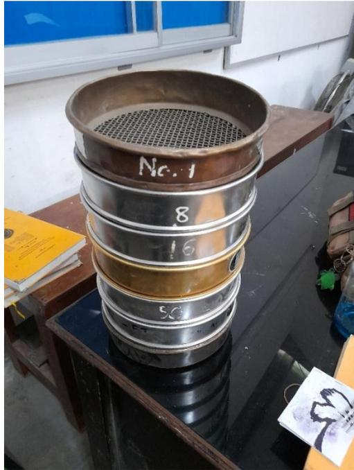
Gambar L- 3 : Saringan Agregat Halus
