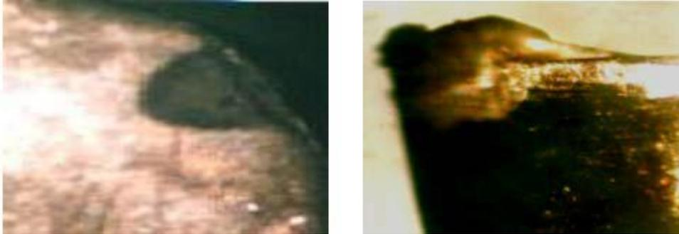
**Gambar 4.5 (a) Keausan Kawah Akibat Mekanisme Adhesi**
