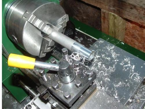
**Gambar 3.8 Benda Kerja Dicekam pada Spindel**
