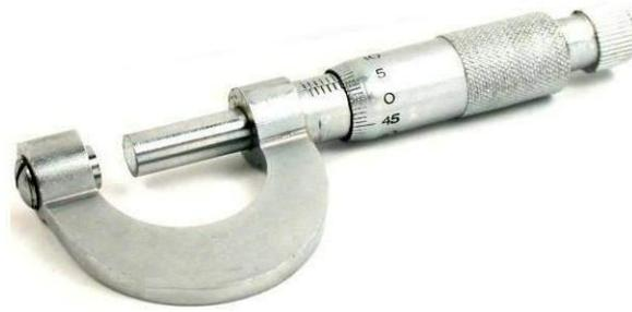
**Gambar 3.6 Mikrometer**
