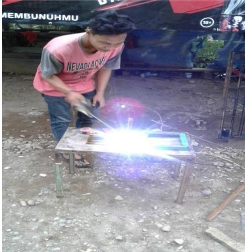
Gambar 3.21 Membuat rangka
