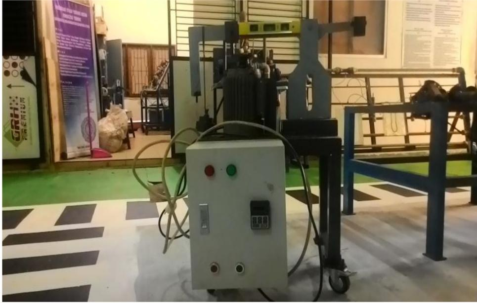
Gambar 4.4 Hasil Pembuatan Mesin Kinerja *Tribologi Pin on Disc*
