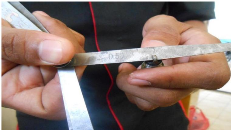
Gambar 3.4: Celah elektroda busi rapat ngk c7hsa (0.5 mm)
