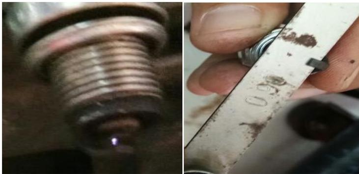
Gambar 4.2: Jarak percikan api busi celah elektroda busi renggang
