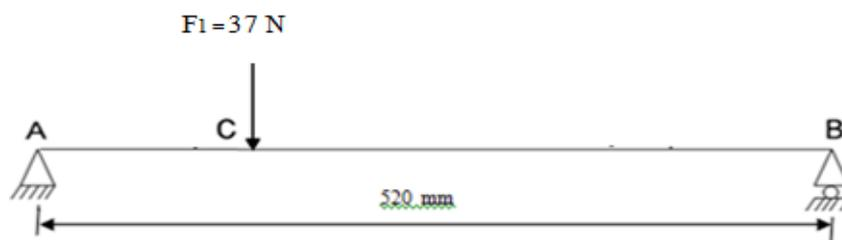
Gambar 4.7 Pembebanan Yang Terjadi Pada Rangka
