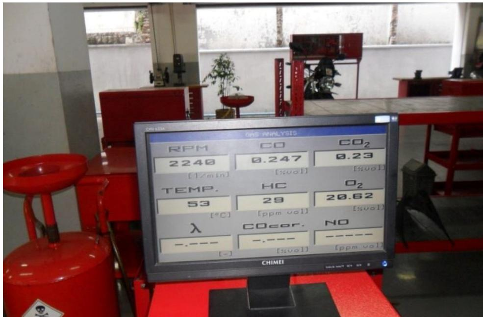
**Monitor untuk melihat RPM, Co, CO<sub>2</sub>, Temp, HS. O<sub>2</sub> DII**
