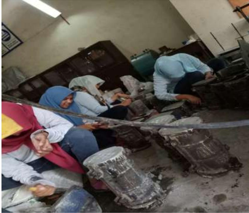
Gambar L7: Beton setelah dicetak selama  $\pm 24$  jam.
