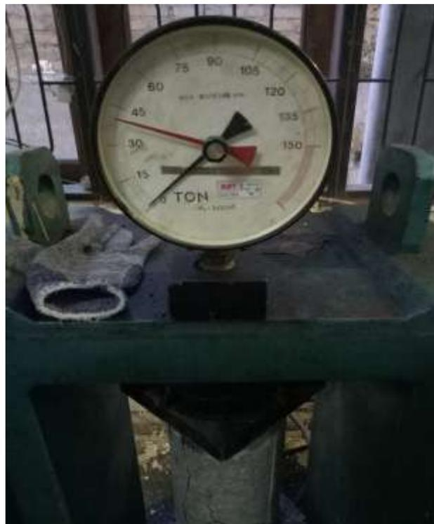
Gambar L12: Uji kuat tekan beton dengan cangkang 10% 28 hari: 40,5 T.
