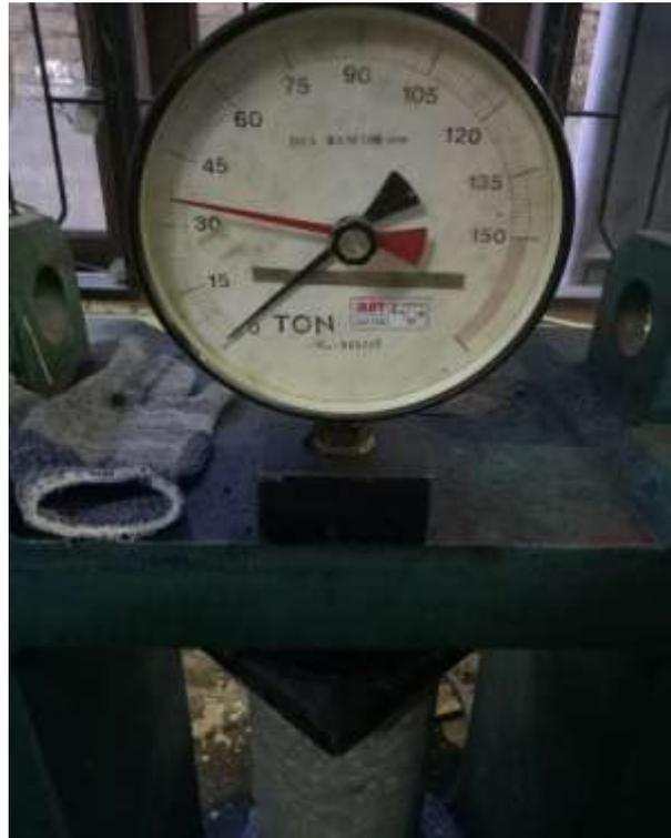
Gambar L13: Uji kuat tekan beton dengan cangkang 12% 28 hari: 36 T.
