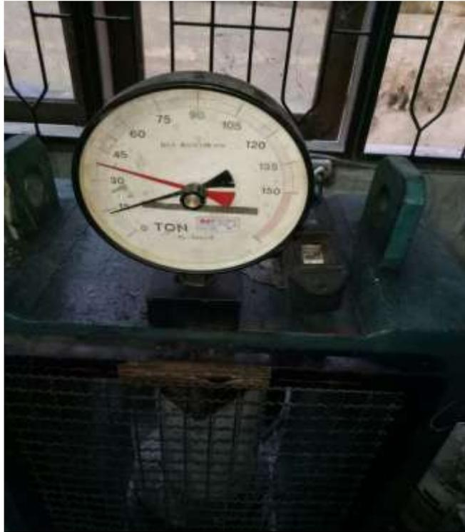
Gambar L11: Uji kuat tekan beton dengan cangkang 8% 28 hari: 37,5 T.
