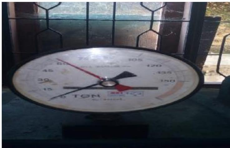
Gambar L25: Uji kuat tekan beton normal 63,5 T.
