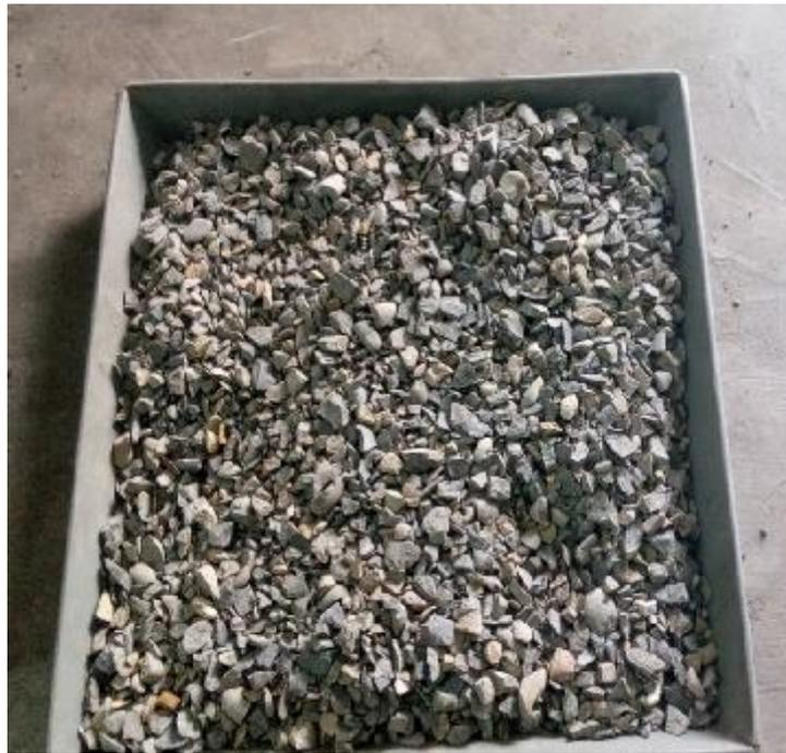
Gambar L1: Material agregat kasar yang akan digunakan.
