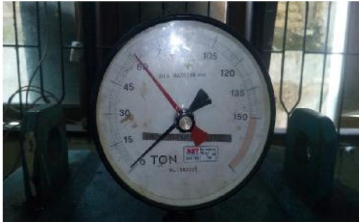
Gambar L24: Uji kuat tekan beton normal 61,5 T.
