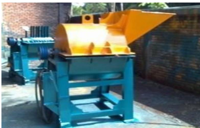
Gambar. 2.1 Mesin pencacah limbah kayu
