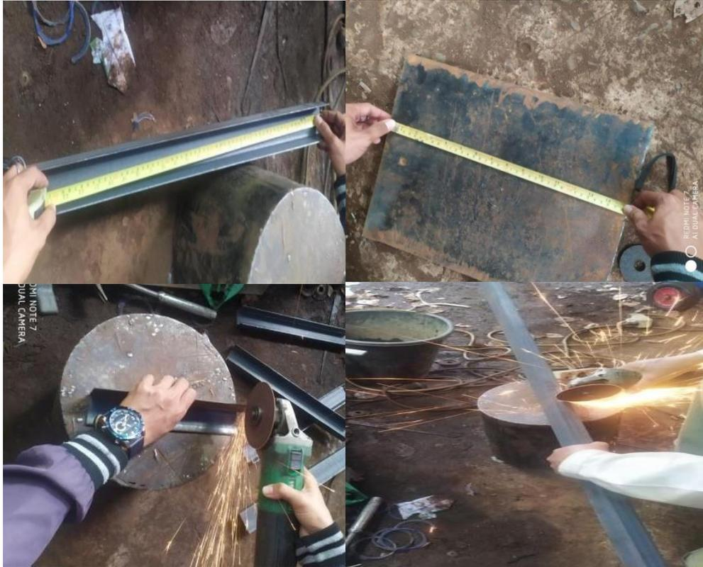
Gambar 4.2. Proses pengukuran dan pemotongan material
