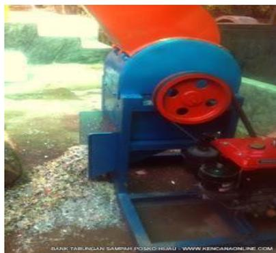
Gambar 2.4. Mesin pencacah limbah plastik
