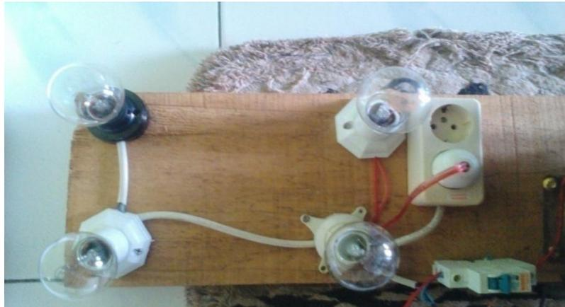
**Gambar 3.5** Beban generator induksi
