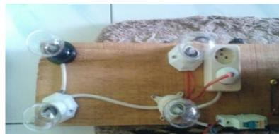
**Gambar 3.9 Beban generator induksi**
