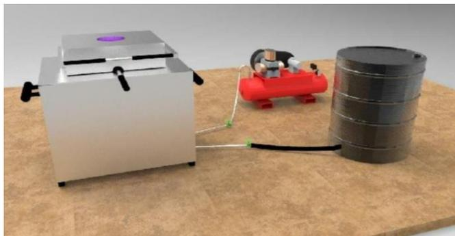
Gambar 2. 6 Tungku peleburan alumunium kapasitas 5kg dengan bahan bakar gas
