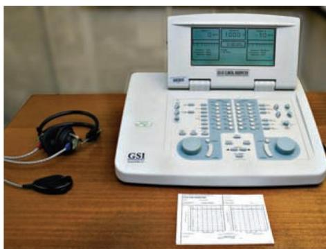
Gambar 2.9. Alat Audiometri<sup>27</sup>
