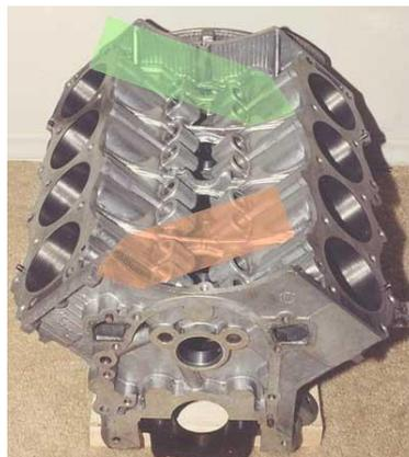
Gambar 2.3. Konfigurasi blok silinder tipe V
