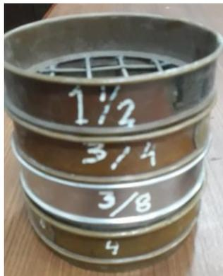
Gambar 3.8: Satu set saringan agregat kasar.
