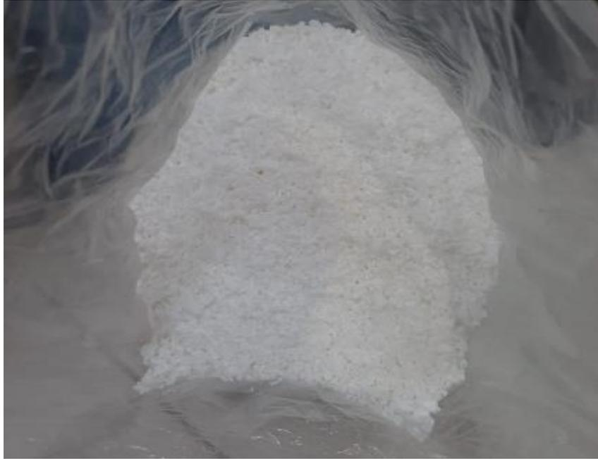
Gambar L.3: Butir *Styrofoam* yang sudah diparut.
