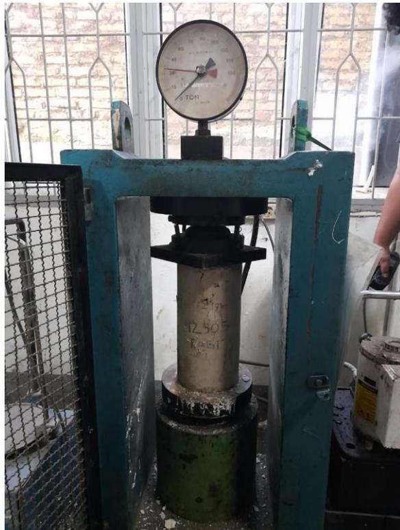
Gambar L.10: Proses uji kuat tekan pada benda uji.
