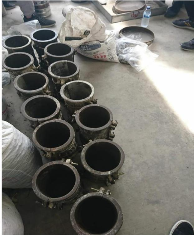
Gambar L.7: Proses perakitan bekisting benda uji.
