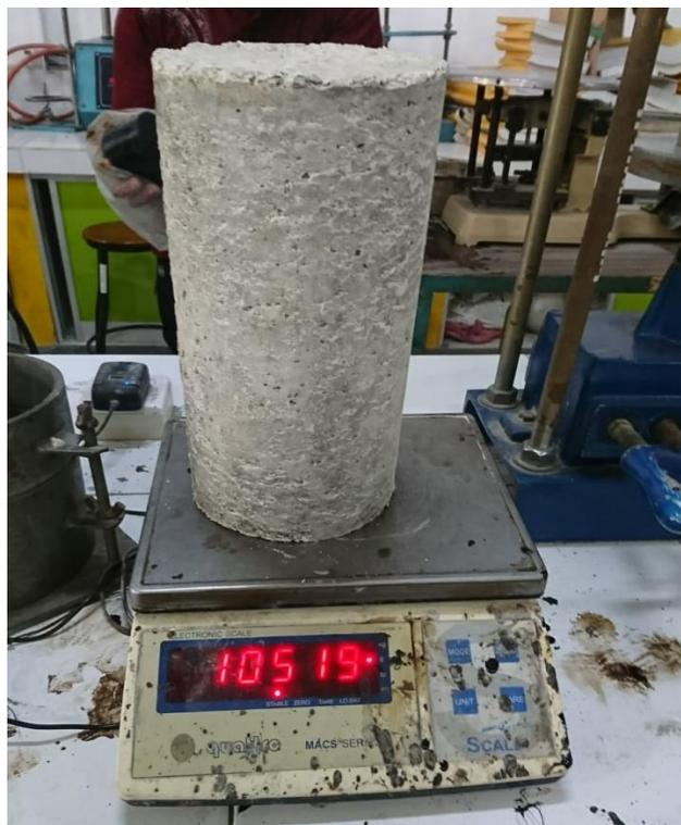
Gambar L.8: Proses penimbangan benda uji.
