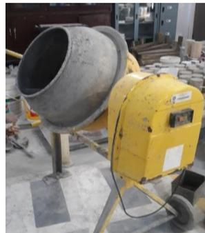
Gambar 3.13: Mesin aduk beton.
