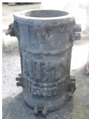
Gambar 3.17: Cetakan silinder.
