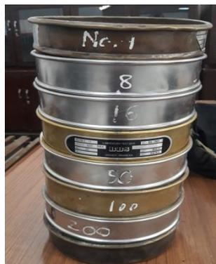
Gambar 3.9: Satu set saringan agregat halus.
