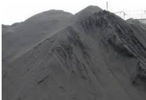
Gambar 3.3: Agregat halus (pasir).
