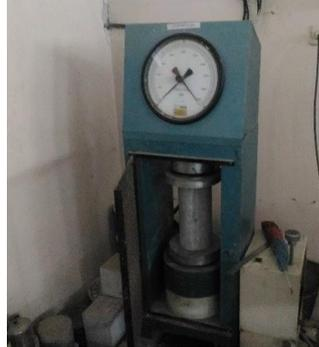
Gambar 3.24: Mesin uji kuat tekan beton.
