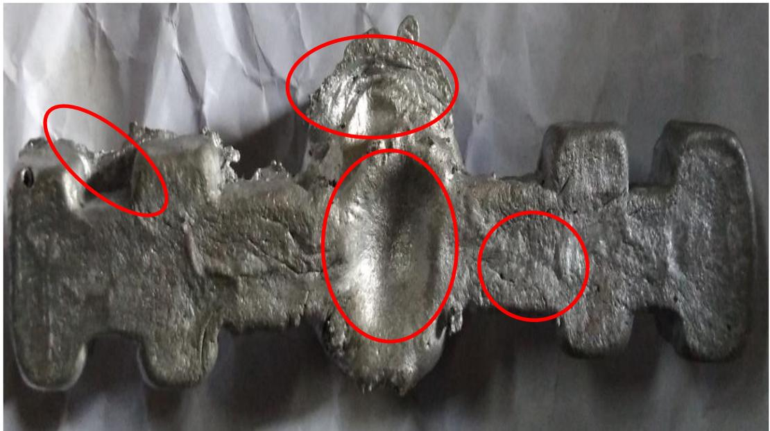
Gambar 4.1. hasil cetakan pada putaran 300 rpm dengan temperatur 500°C dan massa aluminium seberat 70 gr.
