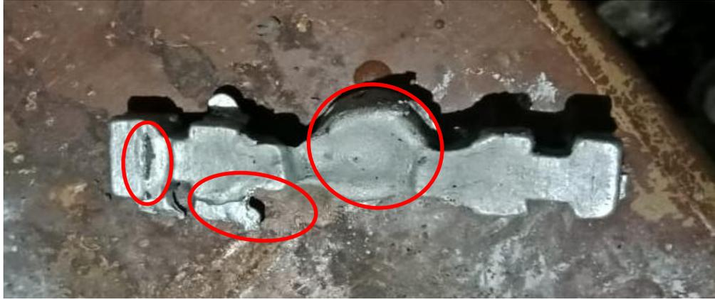
Gambar 4.3. Hasil cetakan sentrifugal pada putaran 300 rpm dengan suhu  $600^{\circ}\text{C}$  dan massa aluminium 70 gr.
