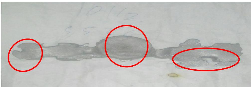
Gambar 4.2. Hasil cetakan pada putaran 300 rpm dengan suhu 550<sup>0</sup>C dan massa aluminium seberat 70 gr.
