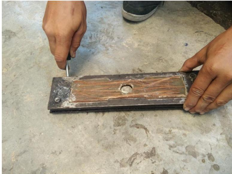
**Gambar 3.24 Proses pengeluaran spesimen dari cetakan.**
