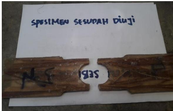
Gambar : 4.6 hasil pengujian tarik spesimen komposit diameter 28 mm
