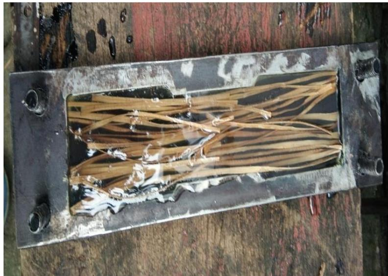
**Gambar 3.23 Proses Pencetakan**
