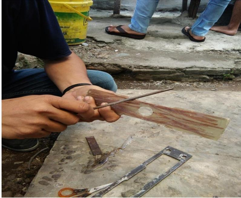
**Gambar 3.26 Pengikiran Spesimen**
