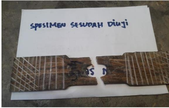
Gambar : 4.2 spesimen komposit sesudah diuji dengan diameter 20 mm
