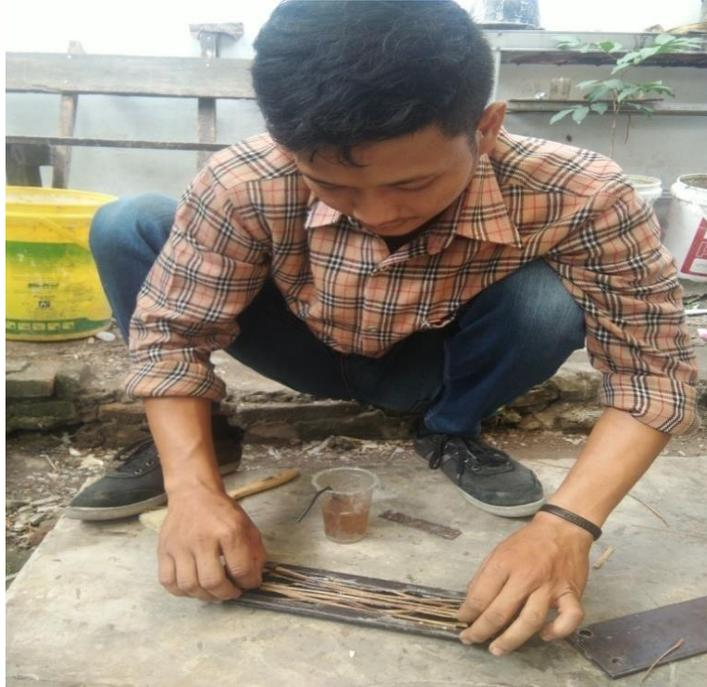
**Gambar 3.22 Penyusunan Serat**
