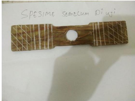
Gambar : 4.3 spesimen komposit sebelum diuji dengan diameter 24 mm
