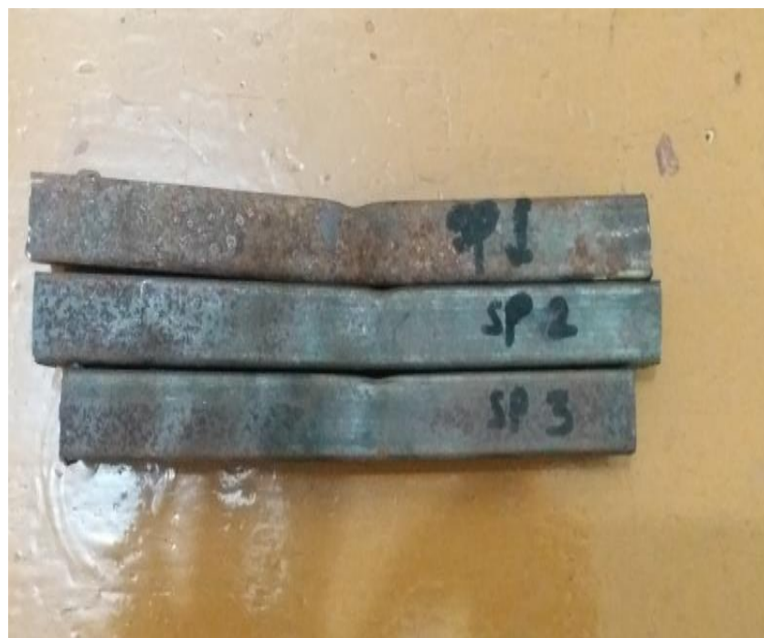
Gambar 3.21. Hasil dari pengujian impact hollow 20 x20
