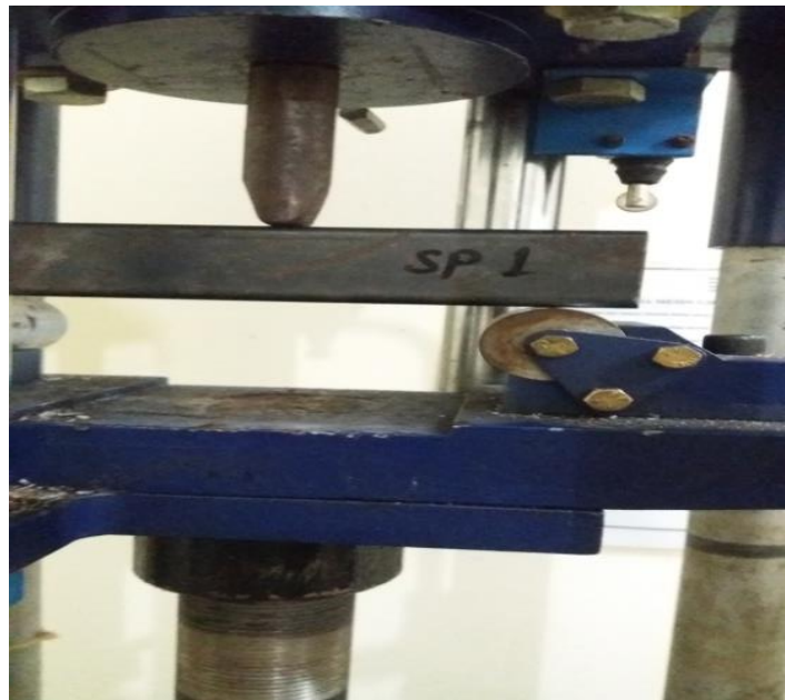
Gambar 3.22. Pengujian hollow 20 x 40 spesimen 1
