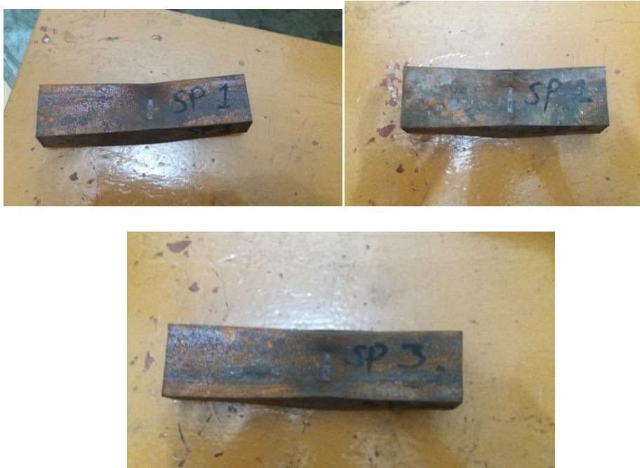
Gambar 3.29. Hasil pengujian besi UNP 5
