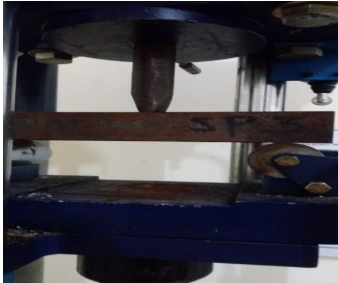
Gambar 3.28. Pemgujian besi UNP 5 spesimen 3
