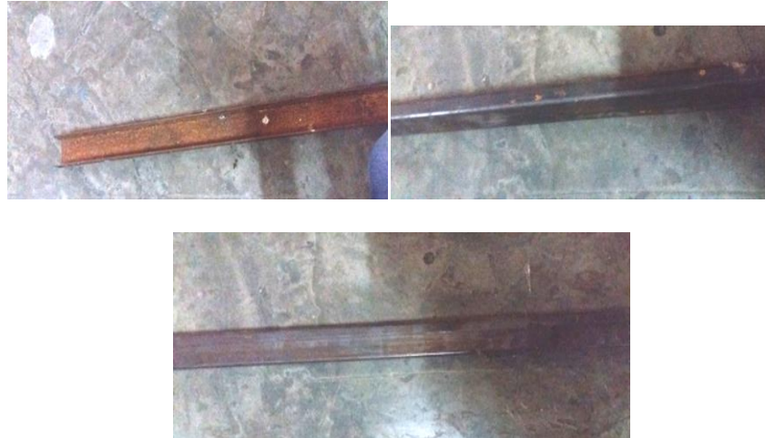
Gambar 3.12. Bahan utama besi UNP 5, Hollow 20 x 40 dan Hollow 20 x 20
