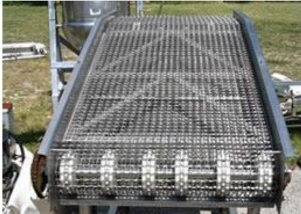
Gambar 2.4 Wire Mesh Konveyor
