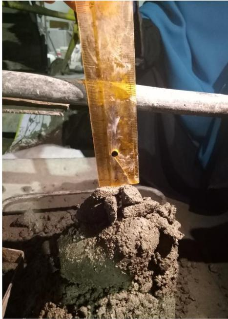
Gambar L5: Proses perlakuan slump test untuk pencetakan beton.
