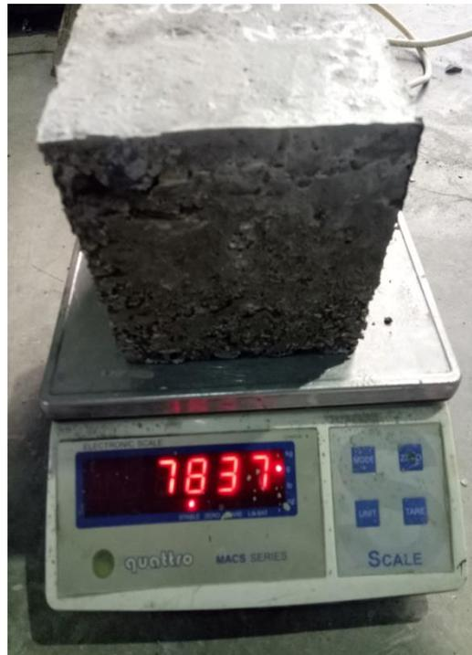
Gambar L6: Menimbang berat beton setelah dibuka dari cetakan.
