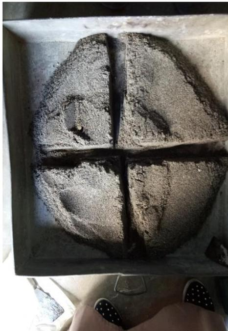
Gambar L2: Proses pengambilan bahan agregat halus untuk melakukan tes dasar.
